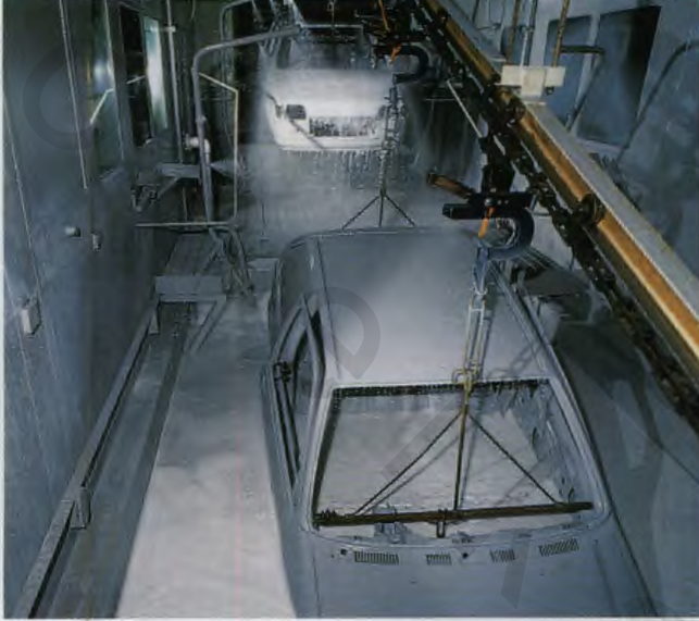
▲ قبل دهان السيارة يتم غمرها بالكامل داخل مغطس طلاء خاص لحمايتها من الصدأ .
