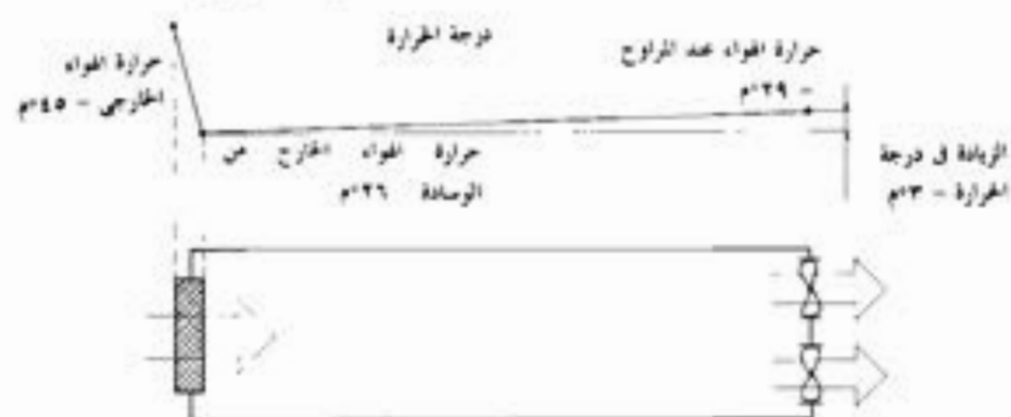
شكل ٢١ - أ : التغييرات في درجة حرارة الهواء المار خلال البيوت المحمية بنظام التروحة والوسادة .
