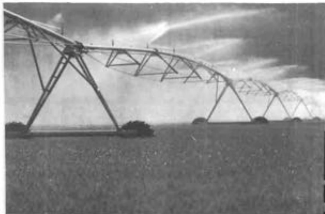
شكل ١٧ - ١٥ : الري بالرش بنظام الري القوي .
