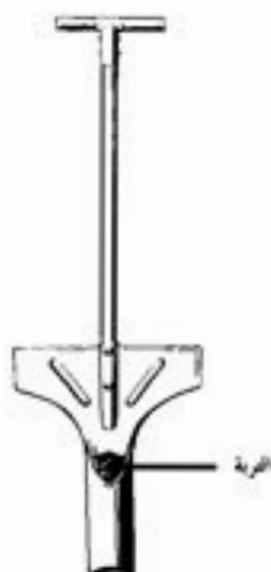
شكل ١٦ - ٥ : الـ bulb setter وهي آلة تستعمل في إحداث ثقب في الغطاء البلاستيكي ، وحفرة بالتربة لوضع الشتلة .
