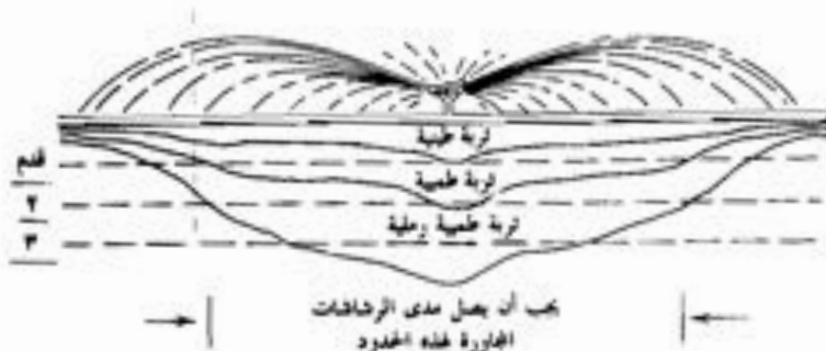
شكل ١٧ - ٩ : مقطع التربة المثلث البناؤه من رشاش واحد في الأنواع المختلفة من الأراضي .
