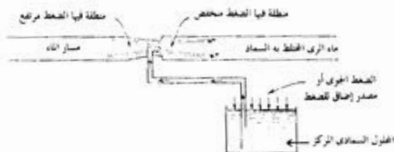
شكل ١٨ - ٩ : طريقة مسطحة خلط المحلول السعادي المركز مع ماء الري . تستخدم هذه الطريقة في تسميد المساحات الصغيرة ، مثل الشتلات والنباتات النامية في الأصص .
