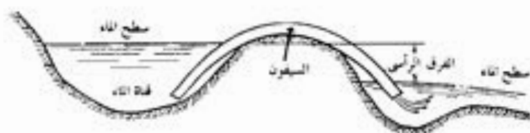
شكل ١٧ - ٦ : الفارق الرأسى (head) في نظام الري بالسيفونات .
