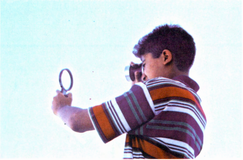
اختبار أولي لعدسة لمعرفة طول قصبة تلسكوب كبلر
