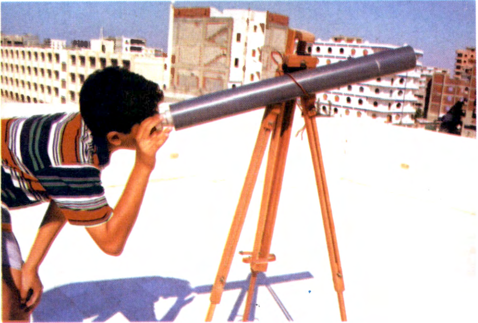
اختبار تلسكوب كاسر بمشاهدة طبق تليفزيون بعيد
