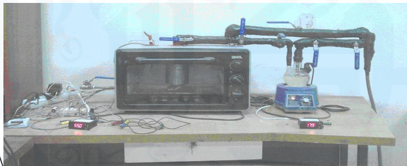
الشكل (1): الجهاز التجريبي المستخدم لتوصيف الحساسات لأجل الأبخرة
