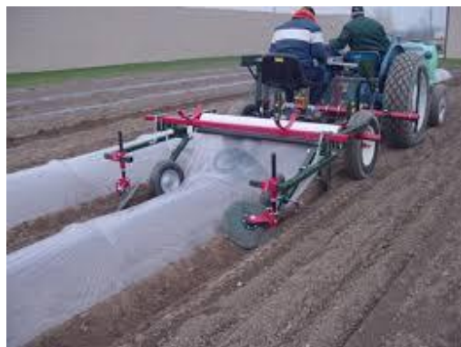
شكل (١٣-٥): فرد الغطاء البلاستيكي آلياً فوق الأقواس.
