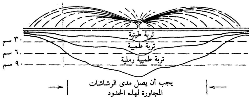
شكل (١٦-٨): مقطع التربة المبتل بالماء من رشاش واحد فى الأنواع المختلفة من الأراضى.
