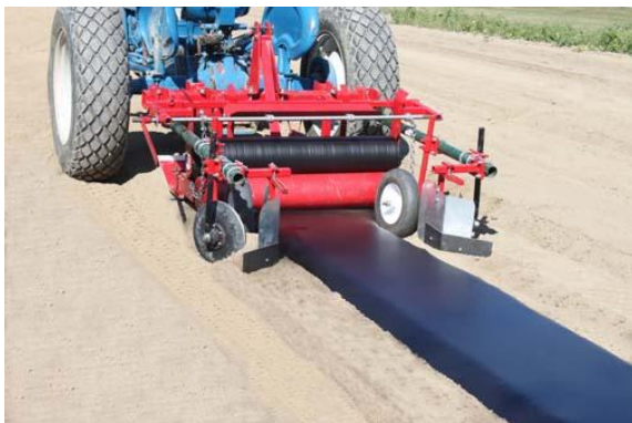
شكل (١٥-١): تثبيت الغطاء البلاستيكي آلياً.
