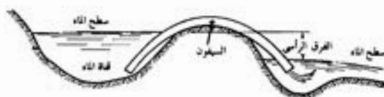
شكل ٧ - ١ : الفارق الرأسى (head) في نظام الري بالسيفونات .
