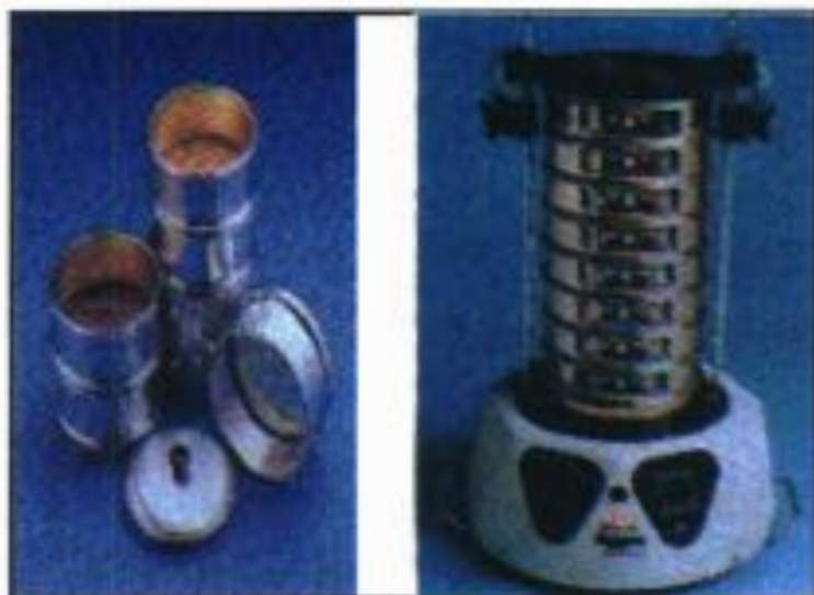
شكل (14-4) غرايل التربة الهزاز وغرايل يدوية مختلفة الأحجام.
