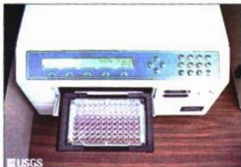
شكل (15-6) جهاز حساب الكثافات (Mnase, A, 2007) .plate spectrophotometer
