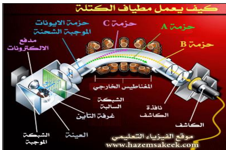
الشكل (8) آلية عمل مطياف الكتلة
