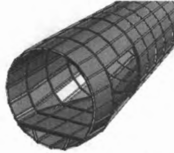
semi monocoque structure هيكل شبه أحادي القشرة
