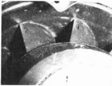
نصل دقاعة impeller blade
