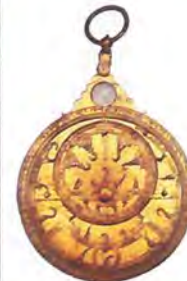
الاسطرلاب آلة فلكية قديمة لقياس ارتفاع الشمس أو النجوم، وكانت أداة مساعدة في الملاحة البحرية، وهي اختراع عربي على الأرجح
