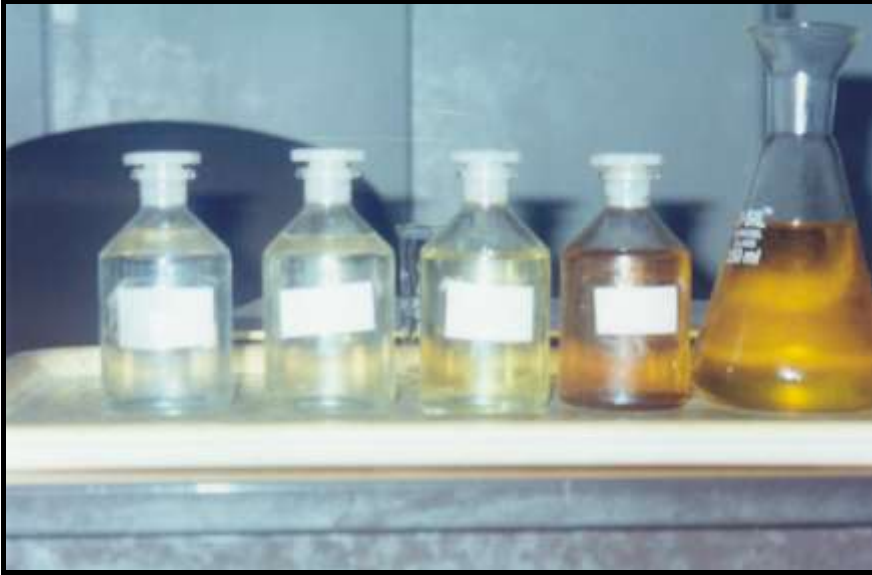
صورة (5) : مراحل إنتاج الزيت من اليمين: الزيت الخام - التعادل - التبييض - التنقية - إزالة الروائح.
