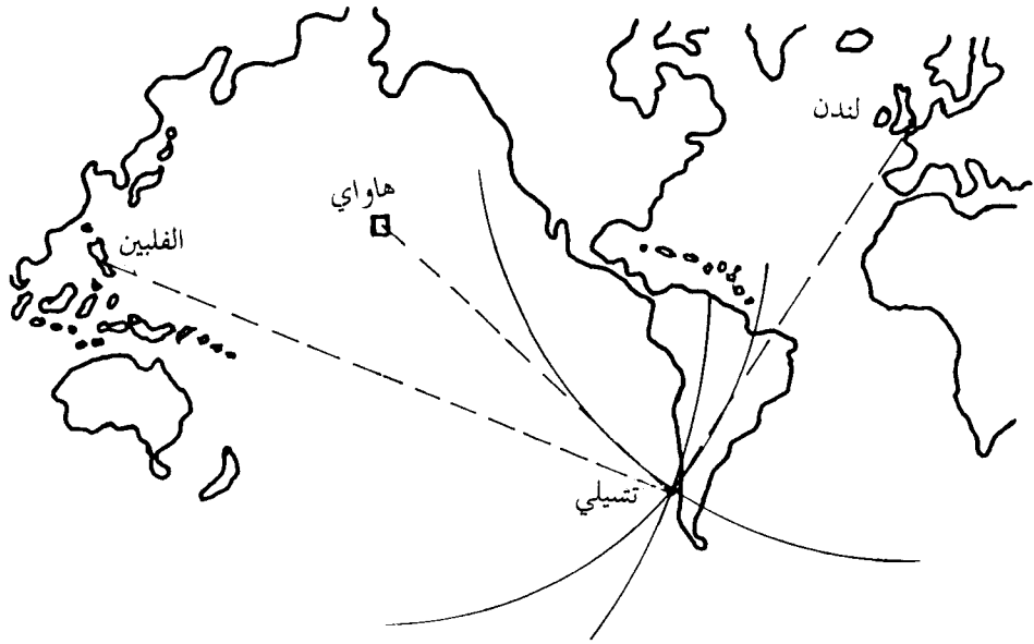
الشكل رقم - ٣٢ - تحديد موقع الزلزال من خلال ثلاث محطات تسجيل سيزموجرافية. «الزلزال في تشيلي»
