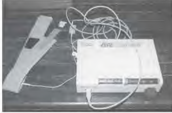
الشكل رقم (٩٣،٧). جهاز مراقبة توقف التنفس بالممانعة عبر الصدر ومعدل ضربات القلب.
