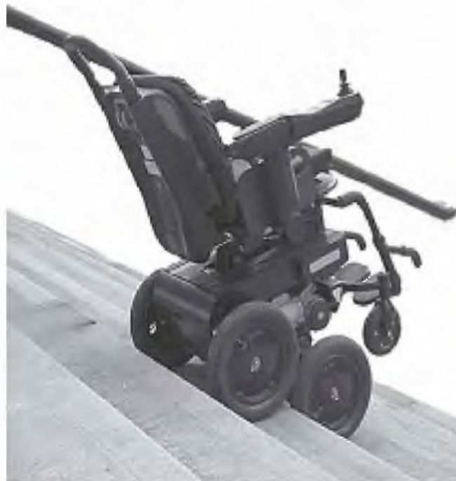
الشكل رقم (١٩، ٩٥). كرسي متحرك ذو تكنولوجيا متقدمة: نظام تنقل INDEPENDENCE™ IBOT™ 3000. إن هذا الكرسي المتحرك قادر على صعود الدرج ونزوله، وعلى الخفاف والوقوف على عجلتيه الخلفيتين لوضع راكبه عند مستوى العين بالنسبة لشخص بالغ واقف.
