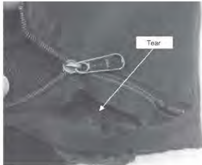
الشكل رقم (٩٥،٢٦). وسادة مقعد نوع Torn تسمح بدخول القذارة والطفيليات.
