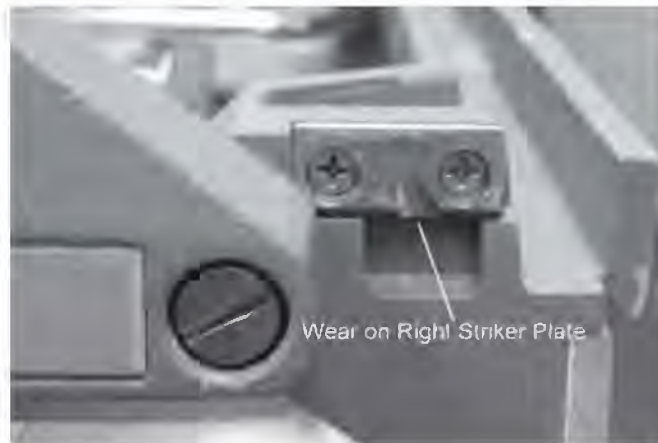
الشكل رقم (٩٥،٨). الصفيحة الضاربة لمزلاج باب حاضنة تبين تآكل المعدن الطري للوحة. لقد مكّن مثل هذا التآكل الرضيع من فتح الباب بمجرد الانكساء أو الميل عليه. مُستسَخنة بإذن من (Shepherd 2003).
