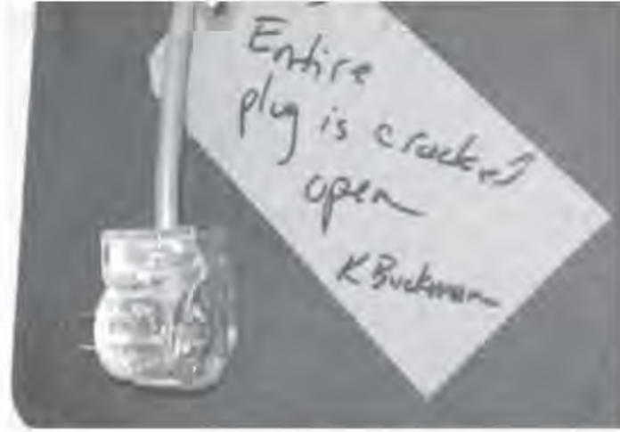
الشكل رقم (٧٦,٥). حقوق مصددة لوحظت في قابس سلك التغذية بالطاقة لمبخرة.
