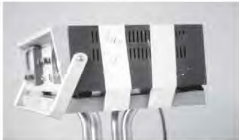
الشكل رقم (٧٦،١). شريط لاصق أبيض، ويعرف أيضاً باسم "شريط الممرضة"، مستخدم لتثبيت مونيتر على حامل.
