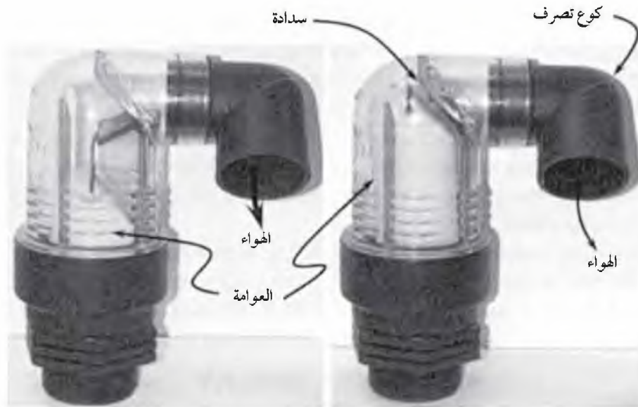
الشكل رقم (١٥, ١٢). صورة لصمام الهواء التجميعي عندما يكون الطفو في الوضع السفلي وعندما يرتفع ليعمل بطريقة مستمرة.
