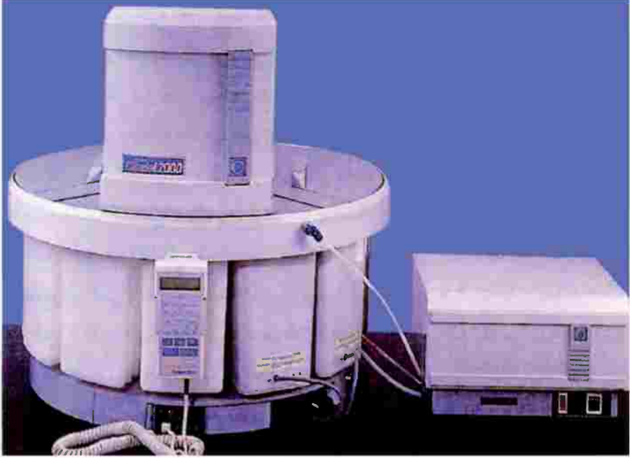
الشكل رقم (٤١). صورة ضوئية لجهاز معاملة الخزغ النسيجية Tissue processor .
