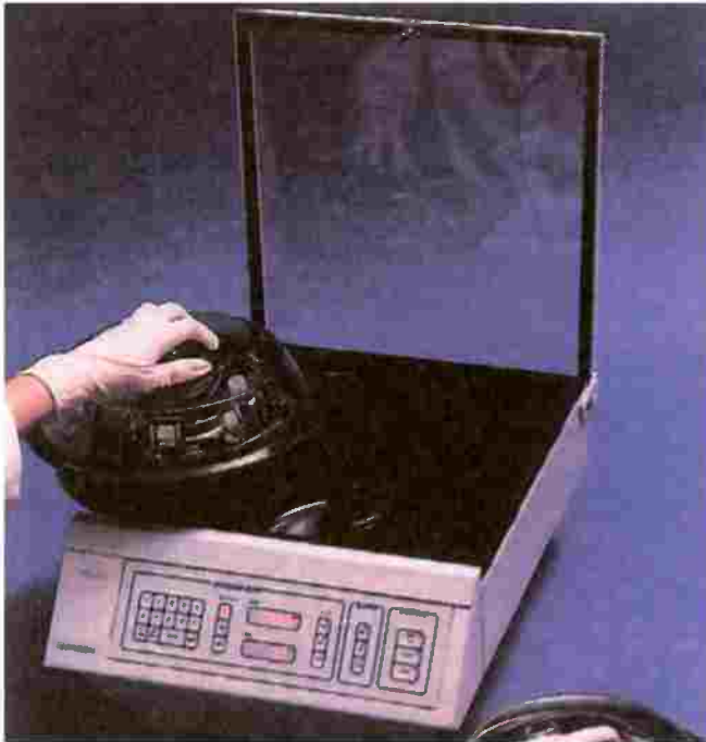
الشكل (٧٦). صورة ضوئية لجهاز Cytospin المستخدم في تحضير مسحات خلوية لسوائل الجسم.
