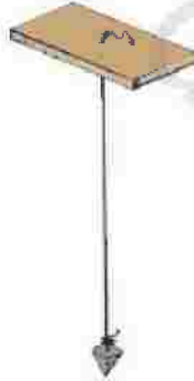
الشكل رقم (٨, ٨). الشاهول - ثقل مخروطي بطرف الخيط [٧].
