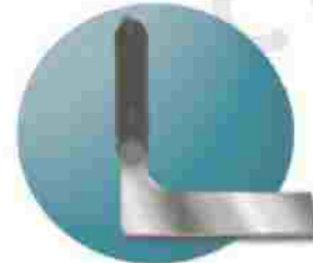
اداه تستخدم فى تركيب الحبل داخل تجويف الاطار
