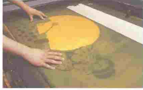
١ تثبيت الاستنسل الشبكي ملاصقا مع سطح الورق
