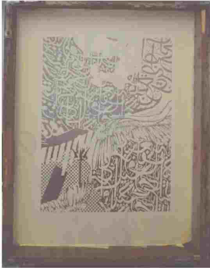
تابع شكل ( ١٢٨ ب ) شكل الاستنسل الفوتوغرافي للون الاسود بعد الاظهار
