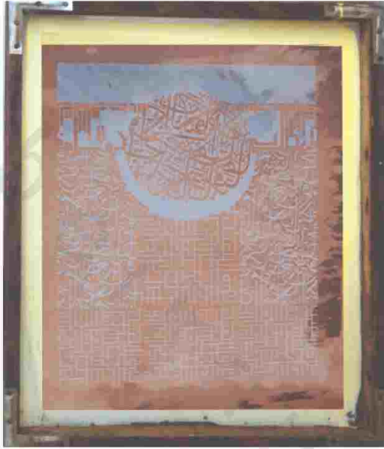
شكل ( ١٢٣ ) استنسل فوتوغرافي على الحزير وجاهز للطباعة على سطح المعدن
