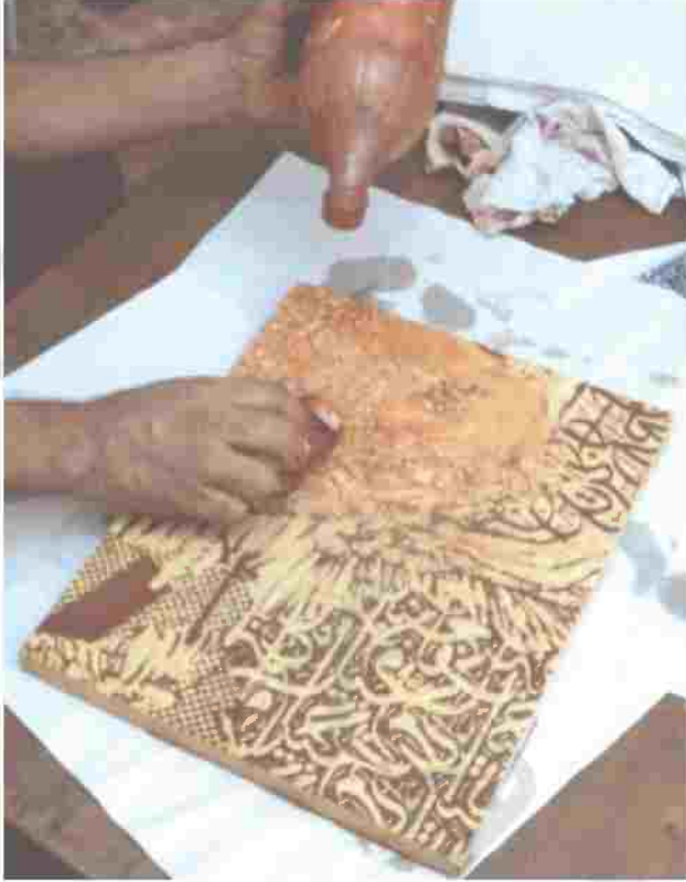
شكل ( ١٣١ ) إزالة المقاوم الحفرى بعد الحفر باستخدام البنزين أو التلتر
