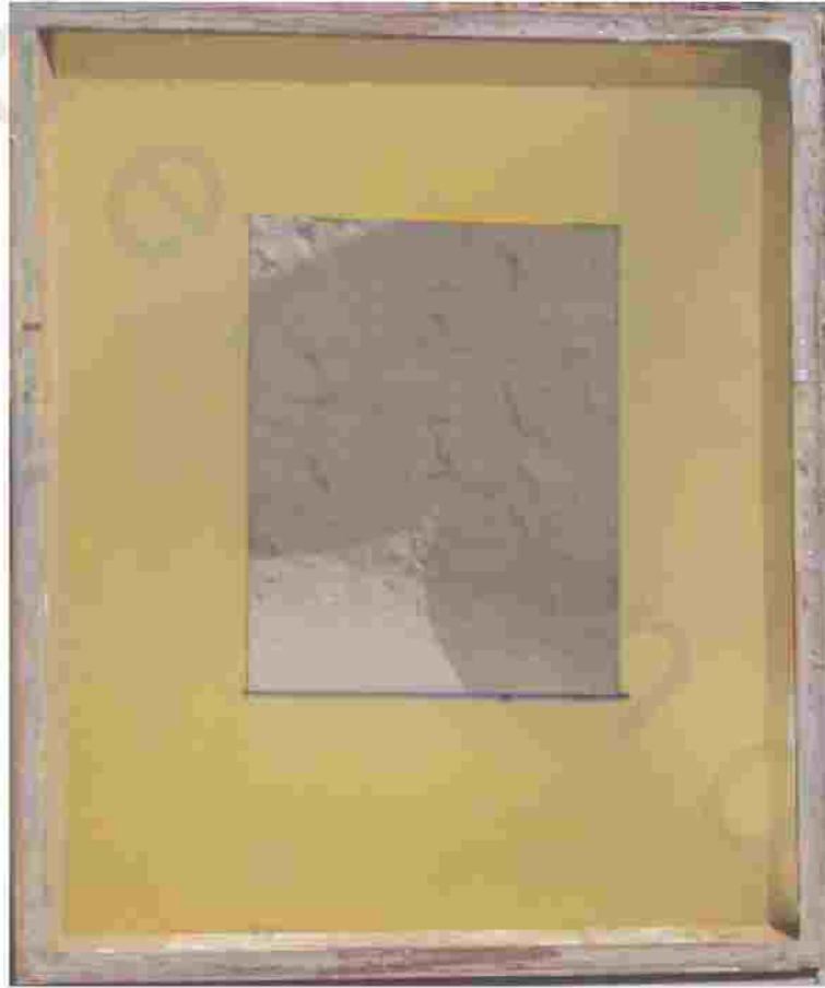
شكل ( 82 ) الاطار الطباعي وعزل حوض الحبر
