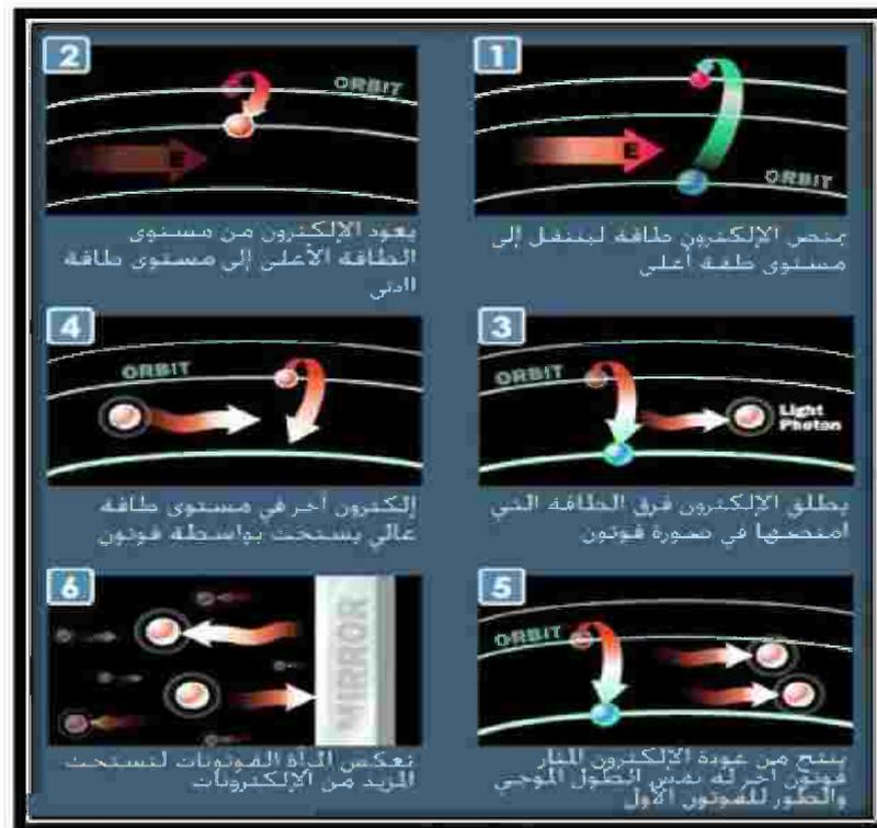
شكل (١٦٤) <sup>(٢)</sup> "تسلسل مراحل إنتاج شعاع ليزر"
