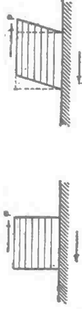
شكل رقم (٧ - ١) القوى المسببة للانس تؤثر في اتجاه مواز للقطع المستعرض للجسم
