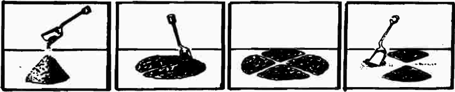
شكل رقم ( ١ - ٢٥ ب ) طريقة التقسيم الرباعي لتحضير عينة للاختبار الركام
