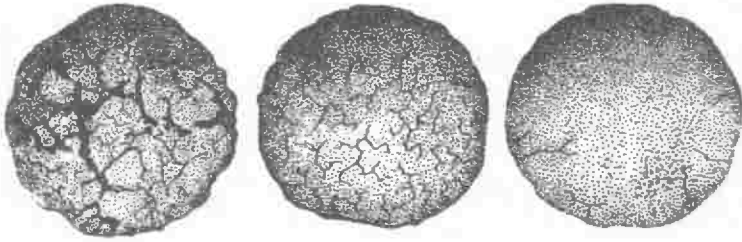
التشققات بكتلة الاسمنت نتيجة التمدد
