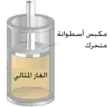
الشكل 1 - 15 غاز مثالي داخل أسطوانة ذات ذراع متحرك
