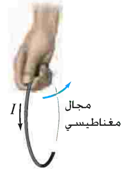
الشكل 20 - 10 قاعدة اليد اليمنى لتحديد اتجاه المجال المغناطيسيّ بالنسبة لحلقة تحمل تياراً كهربائياً.
