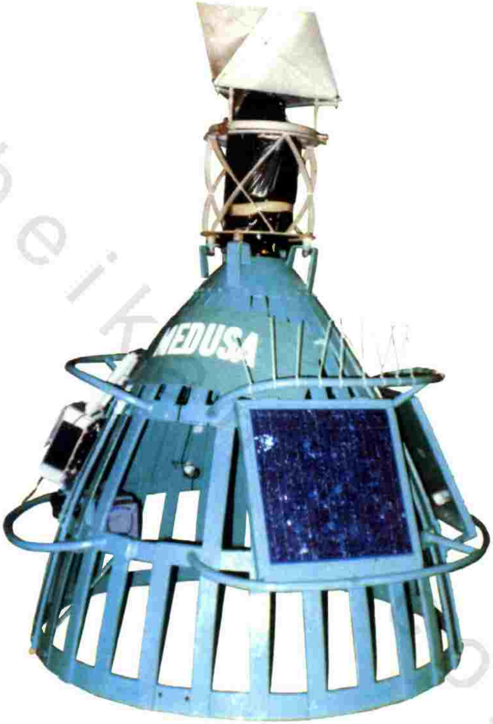
شكل ( ٢٠ ) جهاز يركب على العوامات البحرية (الشمندورة) لإبانتها ليلا حتى تقوم بإرشاد السفن - وهذا الجهاز يعمل بالطاقة الشمسية .
