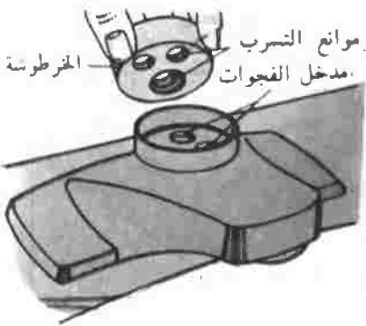
الشكل ٢/١٧ حل الخرطوشة حل المسامير القلاووظ المسكة بالخرطوشة في جسم الصنبور
