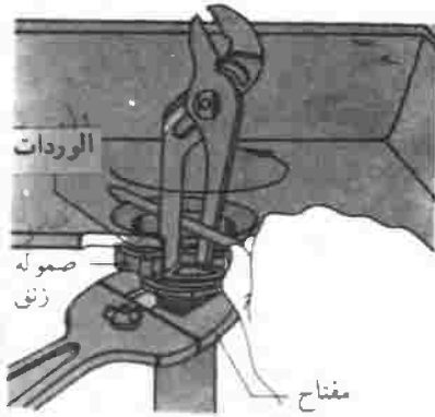
الشكل رقم ٣/١٠ لربط صمولة الزنق للمصفاة: - استخدم زردية ومفكاً
