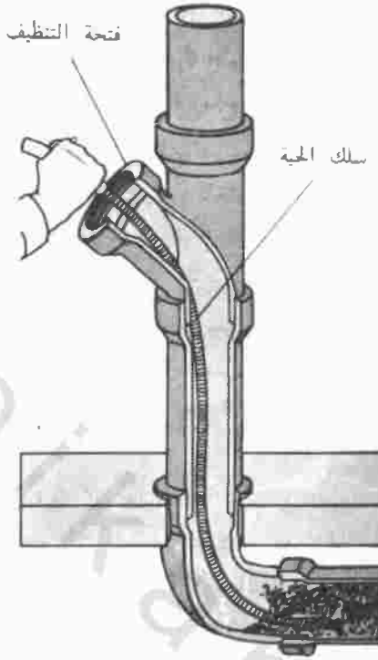
الشكل رقم ٣/٣٥ سلك الحية له القدرة على المناورة حول الانحناءات للوصول إلى مواقع الانسداد الصعبة
