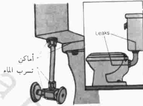
الشكل رقم ٤/٢٣ لعلاج التسرب ما بين السلطانية والخزان والحائط، بتغيير الوردات واللبوسات (الحشيات)
