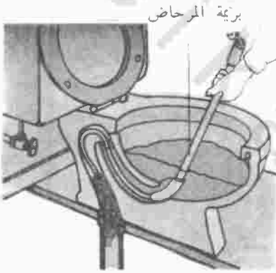
الشكل رقم ٤/٢١ استخدم البريمة المنحنية للوصول إلى أماكن الانسداد العميقة في محبس روائح المراض
