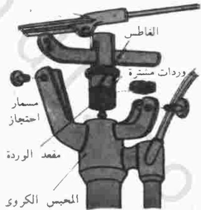
الشكل رقم ٤/٧ لوقف تسرب المحبس الكروي: اخلع الفاطس من المحبس الكروي وقم بتغيير الوردات التالية
