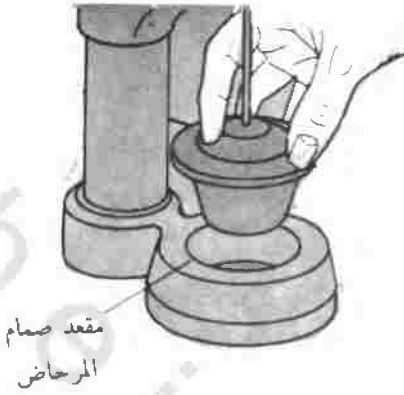
الشكل رقم ٤/١٩ ادفع السدادة في مقعد الصمام
