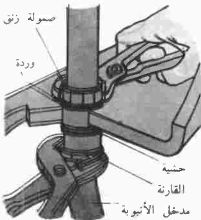
الشكل رقم ٤/٨ الحلج مجموعة المعبوس الكروي استخدم مفتاحين
