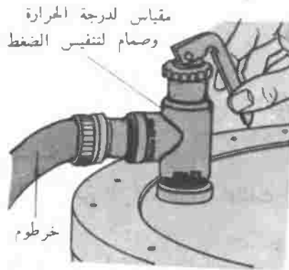
الشكل رقم ٥/١٢ لاختبار مقياس درجة الحرارة وصمام تنفيس الضغط ارفع مقبض الصمام حتى يتم تصريف الماء الساخن
