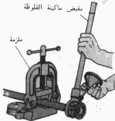
الشكل رقم ٦/٢٣ قلوطة أنبوبة مجلفنة باستخدام ماكينة قلوطة وملزمة
