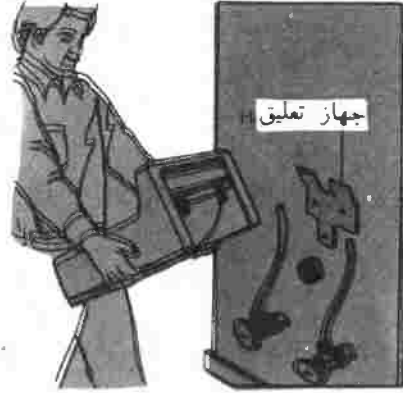
الشكل رقم ٧/١٥ رفع الحوض من جهاز التعليق، ويكون ذلك برفعه رأسياً إلى أعلى
