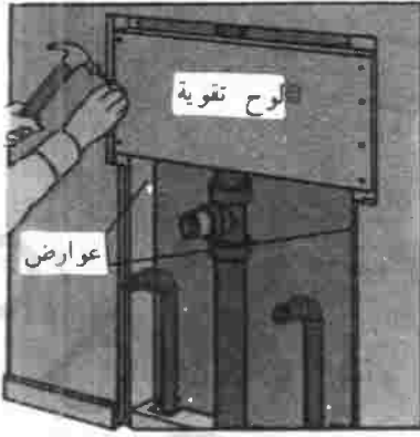
الشكل رقم ٧/١٦ تركيب لوح التقوية
