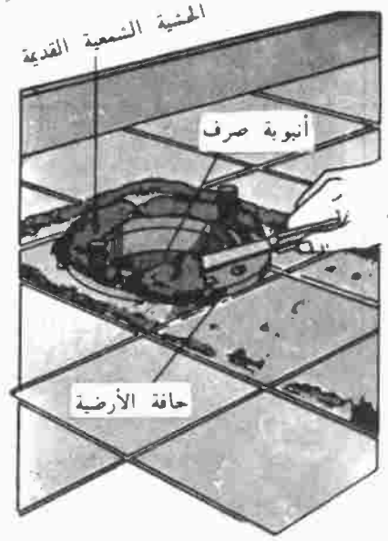
الشكل رقم ٧/٣٩ اكشط اللبوس الشمعي القديم من حافة الأرضية مستخدماً سكين مدّ المعجون
