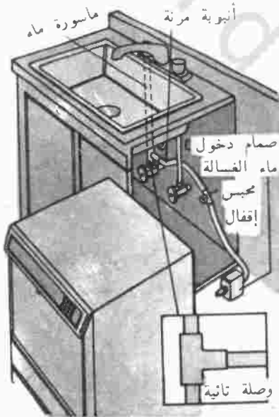
الشكل رقم ٧/٤٤ تركيب وصلة ثانية على ماسورة إمداد الماء، ومد أنبوبة قابلة للانشاء من ماسورة الإمداد إلى غسالة الصحون
