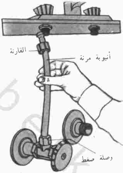
الشكل رقم ٧/١٤ تعليق المعبس إلى الأداة الصحية يكون بتثبيت القارئة والوصلة على الأنبوبة المرنة القابلة للتشنية
