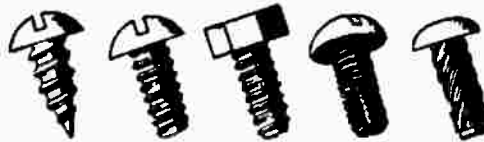
٢-٨ أنواع المسامير الملولة المستخدمة فى تثبيت الألواح المعدنية .
