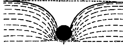
شكل رقم ( ٩٦ ) الإبرة الطافية على سطح الماء . الصورة اليمنى - المقطع العرضي للإبرة ( سمك ٢ مم ) والشكل الدقيق للأثر الذي تخلفه على سطح الماء . الصورة اليسرى - طريقة لجعل الإبرة تطفو على سطح الماء باستخدام قطعة من ورق السجائر
