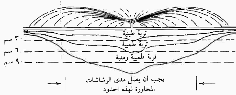
شكل (٦ - ٩) : مقطع التربة المبتل بالماء من رشاش واحد فى الأنواع المختلفة من الاراضى .
