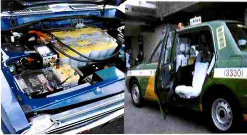
شكل (٤) : موتور سيارة تعمل بالكهرباء التى تم توليدها بواسطة طاقة الرياح حيث يتم شحن البطاريات
