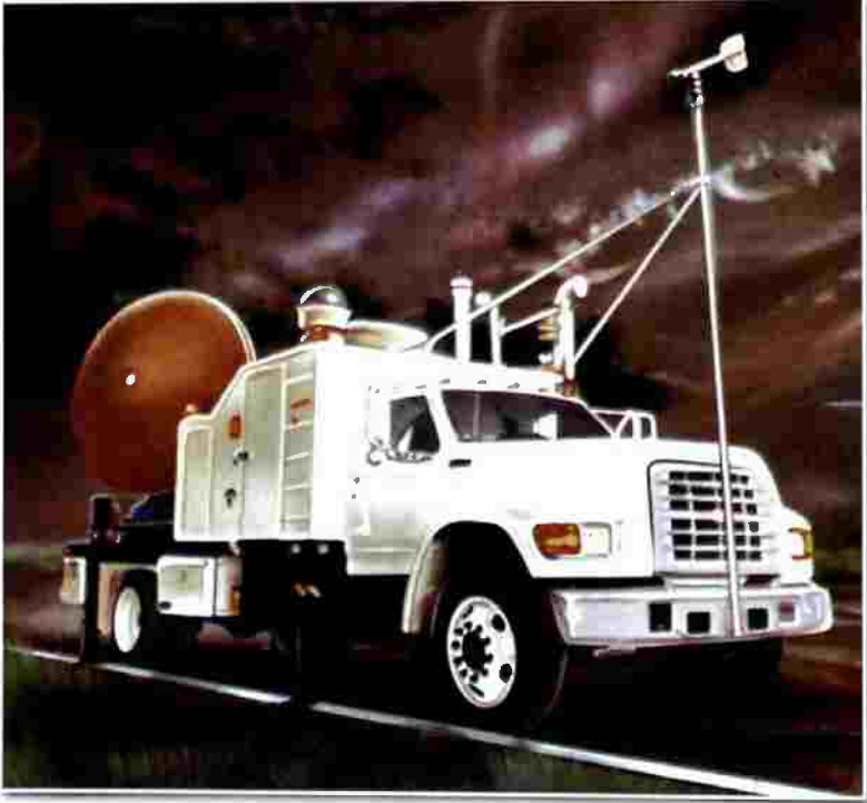
عربة ضخمة مزودة برادار للكشف عن العواصف الدوارة التي تسبق حدوث التورنادو
