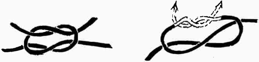
طريقة وصل حبلين بالعقدة البسيطة الشكل النهائي للعقدة البسيطة لوصل طرفي حبلين
