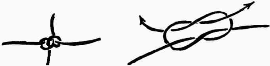
طريقة عقد حبلين لوصل طرفيهما بحيث يكون الطرفان القصيران الناتجان عن العقدة في وضع متعامد مع الحبلين الموصولين
