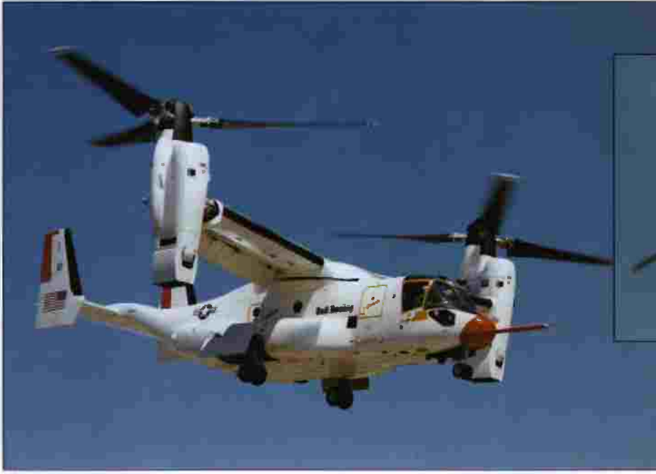
التيلتروتر تقلع عمودياً (اليمين). ثم تطير في إحدى الاتجاهات كالطائرة العادية (أعلى).
