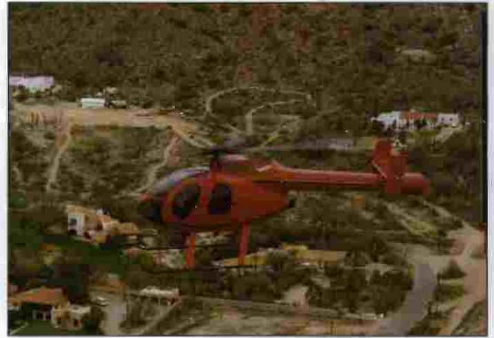
الهيلوكوبتر نوتار لها منفث هواء بدلاً من نظام دوار الدفع الخلفي.
