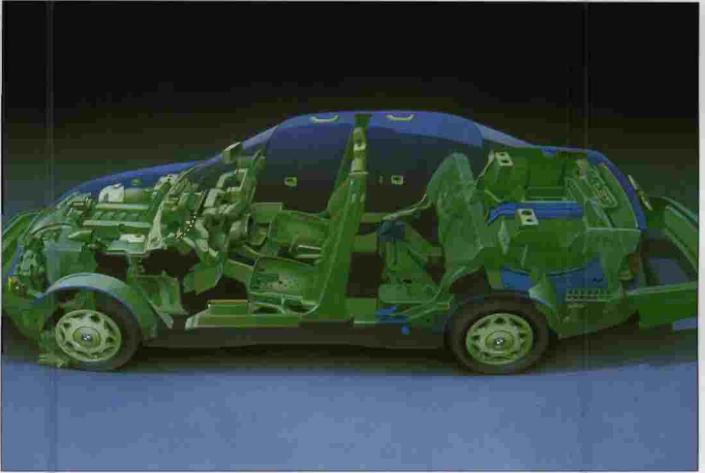
صورة مبتورة لإحدى سيارات سلسلة (بي أم دبليو) الألمانية. القطع الملونة بالأزرق مصنوعة من مواد أعيد تدويرها. القطع الملونة بالأخضر تصلح لأن يعاد تدويرها عندما تصل السيارة إلى نهاية حياتها.
