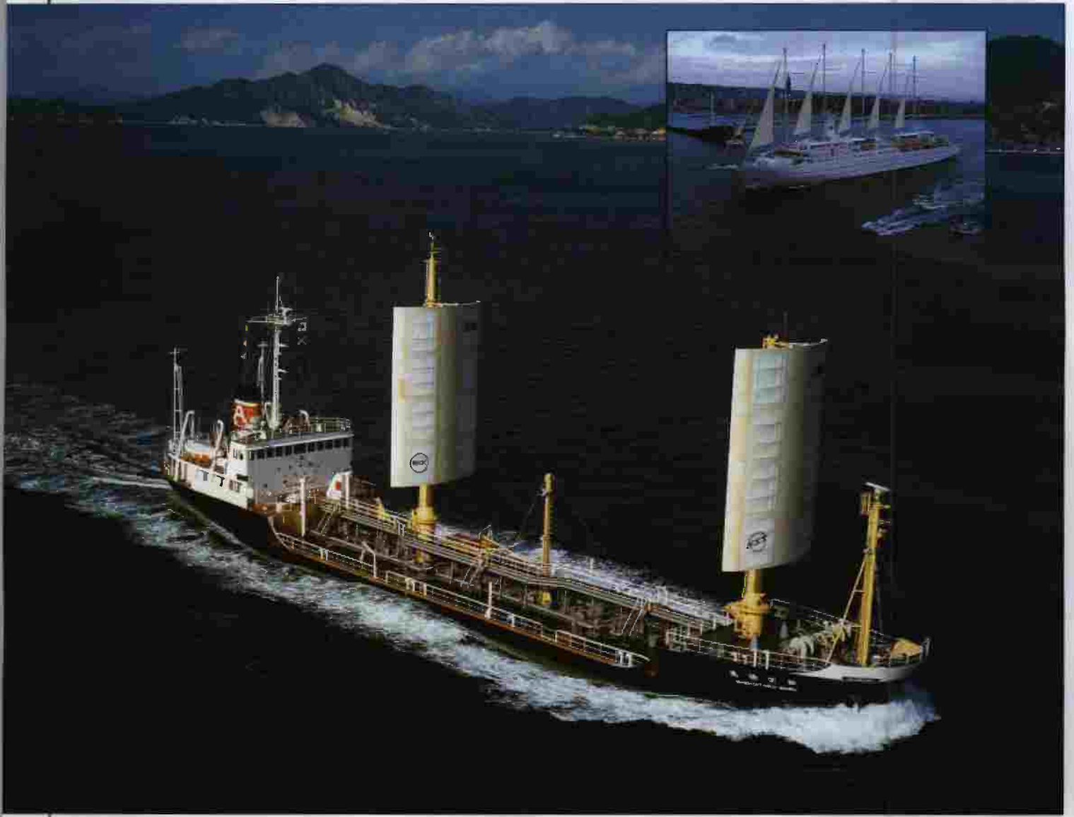
سفينة شينيتوكو مارو وقلاب ميد (صورة الإطار)، وهما مزودتان بأشرعة يتحكم بها الكمبيوتر.
