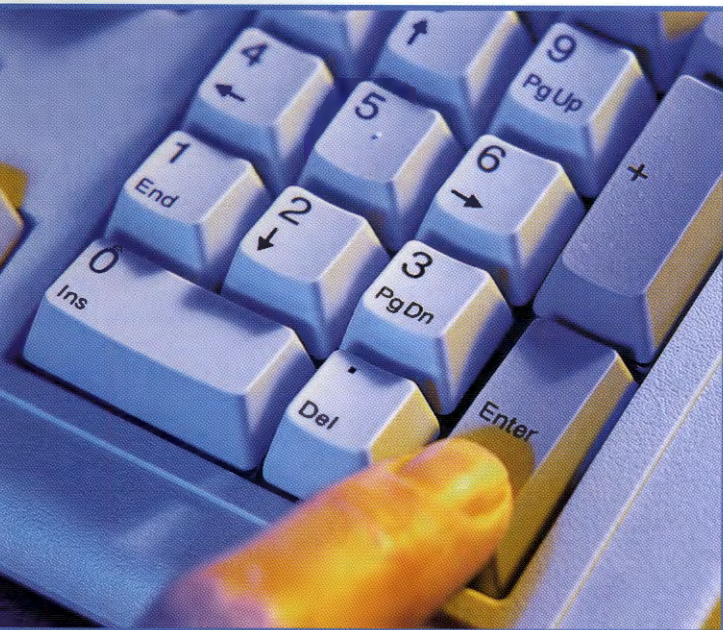
الرموز التي على لوحة مفاتيح الحاسب الآلي مطبوعة بطريقة تسمى طباعة الختامة.
