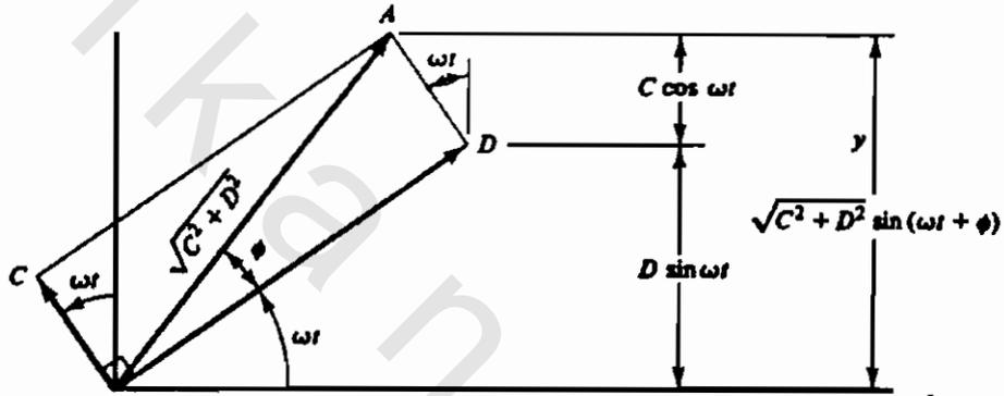
الشكل (1-9) يوضح دوران المتجهات الممثلة بالمعادلة  $y = C \cos(\omega t) + D \sin(\omega t) = \sqrt{C^2 + D^2} \sin(\omega t + \phi)$
