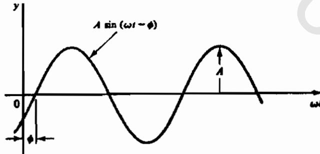
الشكل (1-10) يوضح ان الحركة الموجية تتأخر بزاوية الطور  $\phi$  عن الحركة الممثلة بالعلاقة  $y = A \sin(\omega t)$
