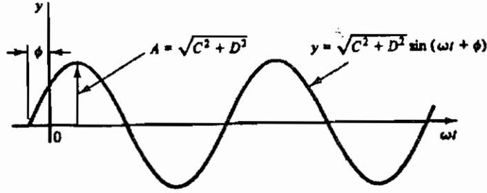
الشكل (1-8) يوضح ان الحركة الموجية تتقدم الحركة الممثلة بالعلاقة  $\sin(\omega t)$  بالزاوية  $\phi$
