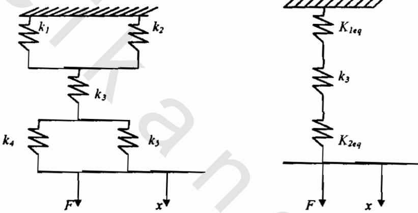
الشكل (2-15a) توضح المنظومة اتصال النوابض على التوالي والتوازي. الشكل (2-15b) المنظومة المكافئة.
