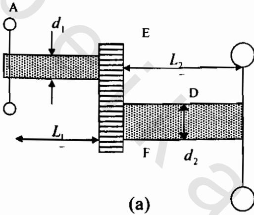
$I_B$  هي عزم القصور الذاتي الكتلي المكافئ للدوار B. ونظراً لأن طاقة الحركة (K.E) وطاقة الأنفعال (S.E) للمنظومة المكافئة يجب أن تساوي طاقة الحركة وطاقة الأنفعال للمنظومة الأصلية.
