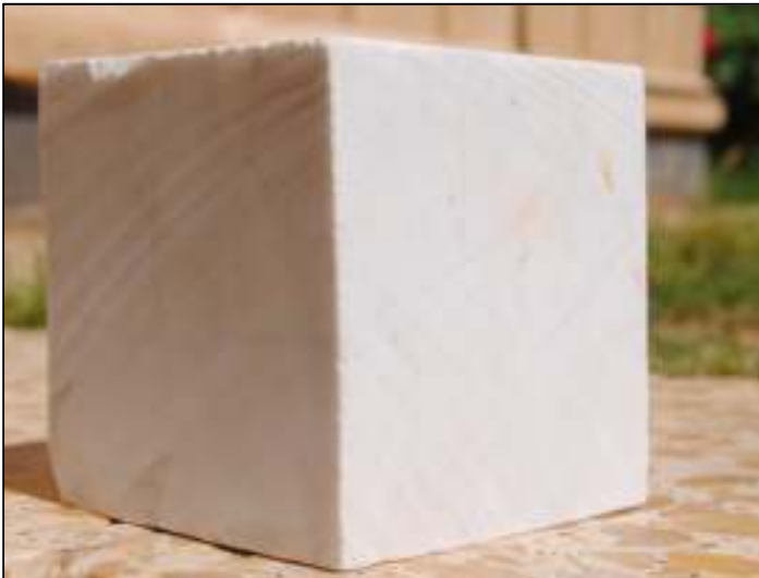
شكل (٧٣) مكعب من حجر الرخام التي تم اخضاعها للفحوصات الفيزيائية
