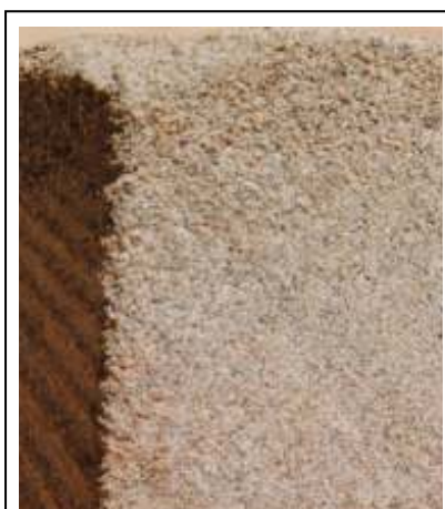
شكل (٧٠) يوضح النسيج المكون لحجر السلتستون
