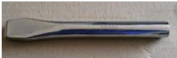
شكل (١٠٦) يوضح شكل ازميل المستو ( المصدر : http://www.ar.aliexpress.comwww.olesal-flat.com )
