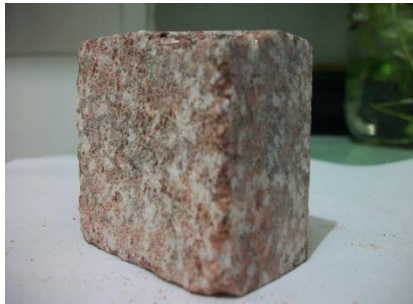
(صورة: ٢٣١) حدثت تغيرات للجرانيت الأحمر الداكن بعد تعرضه لعدد من دورات التجوية الملحية و الحرارية بكبريتات الصوديوم فنلاحظ بهتان اللون الشديد و الخشونة.
