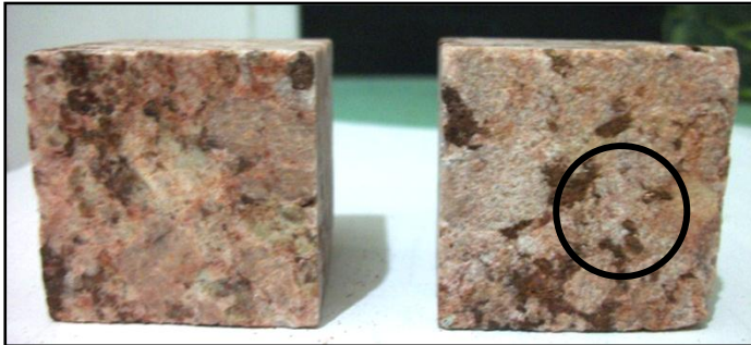
(لوحة: ٢٢٥ أ.ب-ج.د) توضح ما حدث من تغيرات للجرانيت الوردي بعد تعرضه لعدد من دورات التجوية الملحية و الحرارية بأملاح كبريتات الصوديوم حيث نلاحظ التشوهات و انتشار اللون الأحمر نتيجة أكسدة المعادن و التفتت الشديد و البلورات الذهبية الصغيرة و التي يشير السهم إلى واحدة منها.
