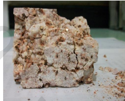
(صورة: ٢٢٩ أ-ب) توضح ما حدث من تغيرات للجرانيت الوردي بعد تعرضه لعدد من دورات التجوية الملحية و الحرارية بأملاح كلوريد الصوديوم حيث نلاحظ التشرخات و الهالات الحمراء حول معادن الميكا السوداء نتيجة التأكسد و التفتت الشديد و البلورات الذهبية الصغيرة و التي يشير السهم إلى واحدة منها.
