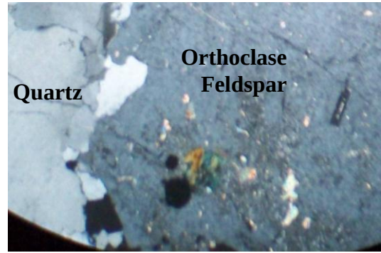
(صورة : ١٤٧) يوضح قطاع S3 والتحول والتغير في معادن الفلسبار أورثوكليز إلى اليمين كما نرى معدن الكوارتز إلى أقصى اليسار.
