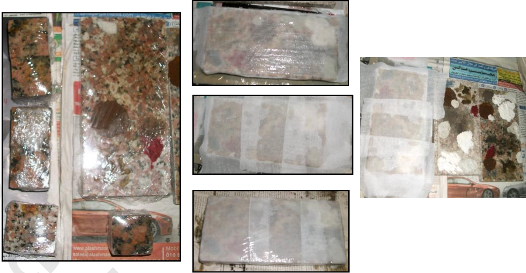
( صورة: ٣٢٥ أ ب- ج د ) توضح تغطية جميع مظاهر التلف الموجودة على البلاطات و المكعبات بمادة الكربوكسى ميثيل سيليلوز المضاف إليها كربونات الأمونيوم ، و المادة الأخرى كربوكسى ميثيل سيليلوز و كربونات الأمونيوم و المضاف إليها ملح الأديتا بوتاسيوم.
