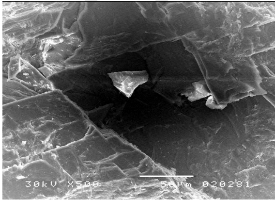
(صورة: ٢٦٢) يتضح من الفحص لعينة الجرانيت الوردى التى تم وضعها بمياه منطقة السلسلة وجود شكل الصفائح المكونة لمادة العينة ( قوة تكبير 500X ).
