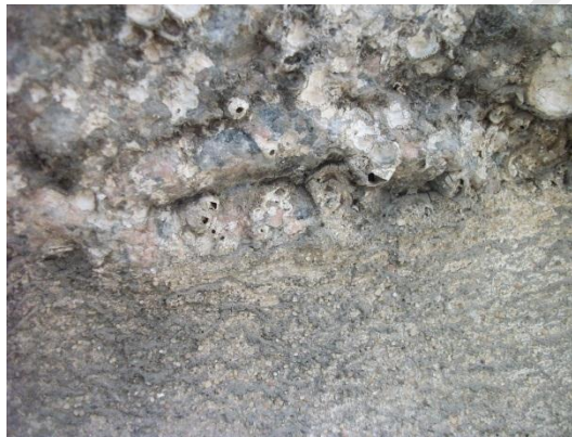
(صورة: ٣٨٤) توضح التلف الناتج بين القاعدة و المونة المكونة لها و التمثال المملوء بالتكلسات البحرية، و لقد أظهر تحليل الـ XRD تكون المونة من الرمل و الـ Calcite كمكونات رئيسية بالإضافة إلى الطفلة (Albite)، و هذا يعني أن هذه المونة عبارة عن مونة الجير، ترتفع فيها نسبة الرمل، كما تعمل مادة الطين مع كربونات الكالسيوم على ربط أجزاء المونة (شكل رقم ٦٧) و (جدول رقم ٢٣) .
