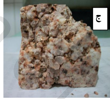
(لوحة: ٢٢٥ أ.ب-ج.د) توضح ما حدث من تغيرات للجرانيت الوردي بعد تعرضه لعدد من دورات التجوية الملحية و الحرارية بأملاح كبريتات الصوديوم حيث نلاحظ التشوهات و انتشار اللون الأحمر نتيجة أكسدة المعادن و التفتت الشديد و البلورات الذهبية الصغيرة و التي يشير السهم إلى واحدة منها.
