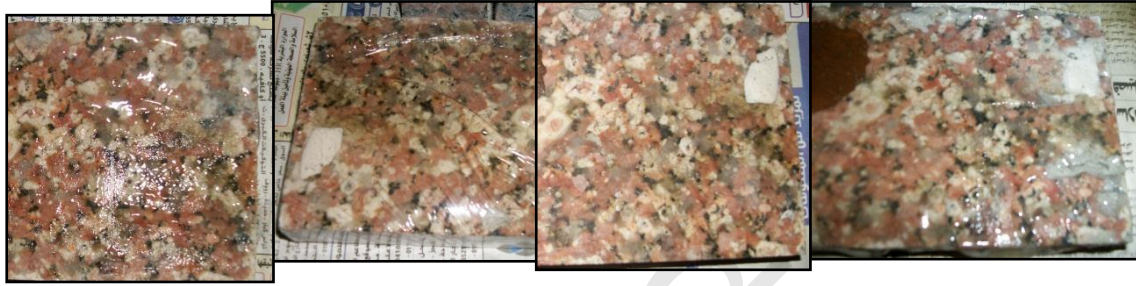
( صورة: ٣٢٦ أ ب- ج د ) توضح عملية إزالة التكلسات الجبسية و الأسمنتية باستخدام كمادة الكربوكسى ميثيل سيليلوز و كربونات الأمونيوم و التى أعطت نتائج جيدة فى إزالة التكلسات نهائياً بعد عدد من المرات.
