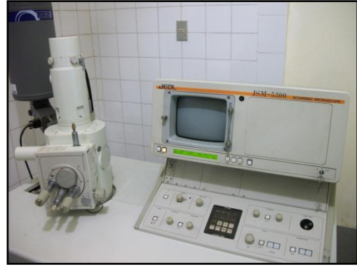
(صورة : ١٥٤) توضح جهاز الميكروسكوب الإلكتروني (صورة: ١٥٥) توضح التحليل الطيفي للعناصر بالإشعة السينية.
