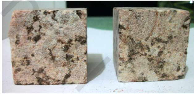
(صورة: ٢٣٤ أ-ب) يوضح ما حدث من تغيرات للجرانيت الأحمر الفاتح حيث حدوث بهتان للون بعد تعرضه لعدد من دورات التجوية الملحية و الحرارية بأملاح بيكرينات الأمونيوم.
