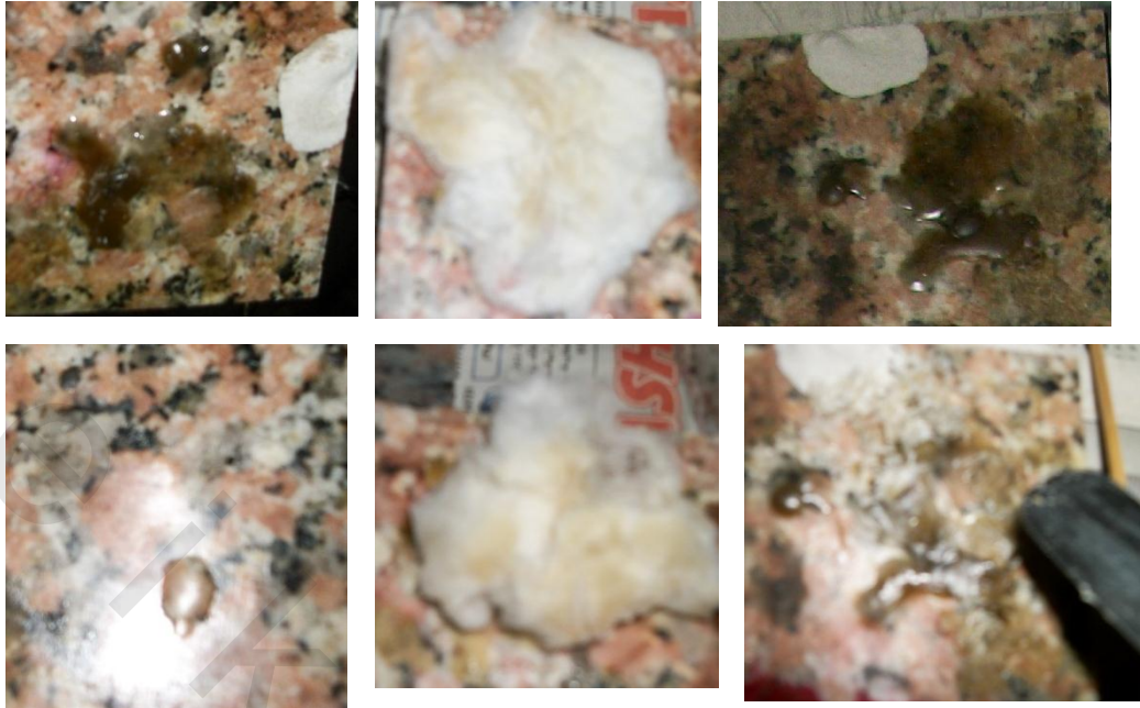
(لوحة: ٣٣١ أ-ب-ج-د) توضح عملية إزالة آثار الشموع و التكلسات الشمعية باستخدام التولوين لإذابة التكلسات ثم إستخدام الطرق الميكانيكية يتببعها تنظيف بالتولوين ثم التنظيف عدة مرات بالماء المقطر.
