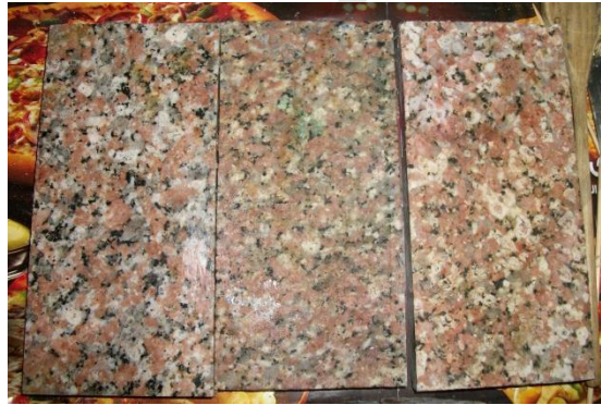
(لوحة: ٣٣٨ أ-ب- ج) توضح البلاطات الجرانيتية قبل و بعد عملية التنظيف.
