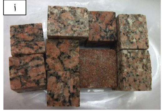
(صورة: ٢٢٤) توضح مكعبات الجرانيت الأنواع بعد الغمر في أملاح كبريتات الصوديوم و قبل وضعهم في درجة حرارة الفرن.
