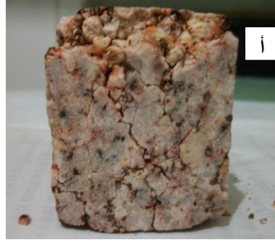
(صورة: ٢٢٤) توضح مكعبات الجرانيت الأنواع بعد الغمر في أملاح كبريتات الصوديوم و قبل وضعهم في درجة حرارة الفرن.
