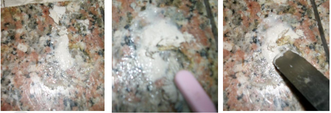
( صورة: ٣٢٨ أ-ب-ج) توضح عملية إزالة التكدسات الجبسية باستخدام بيكربونات الصوديوم + الماء بنسبة ١ : ١٠ جزء.
