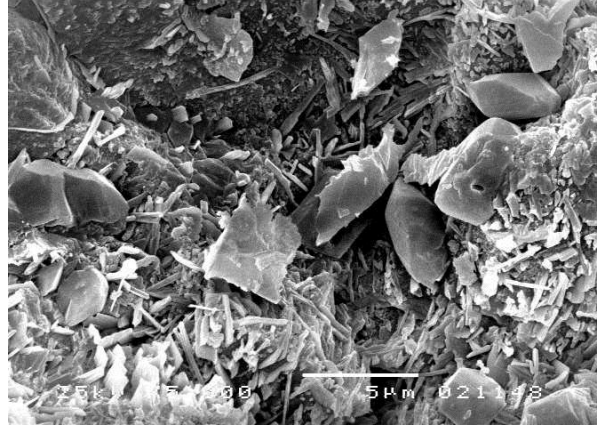
(صورة : ٢٤٢ ) يتضح من الفحص تأثير التجوية الملحية لأملاح كبريتات الصوديوم على مادة الجرانيت الأحمر الفاتح، كما يتضح وجود المعادن الطينية نتيجة التجوية بفعل الرطوبة ( قوة تكبير 5,000X).
