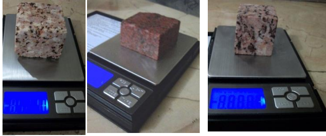
(صورة: ٢٧٢) توضح عملية وزن العينات المختلفة بعد القيام بكل مرحلة من مراحل التقوية.
