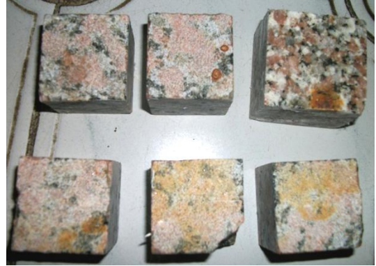
(صورة : ٣٣٧ أ و ب ) توضح بقع الصدأ و الأصفرار نتيجة لتأكسد المعادن الموجودة على أنواع الجرانيت المختلفة في الصورة اليمنى قبل التنظيف ، و المكعبات بعد التنظيف في الصورة اليسرى.
