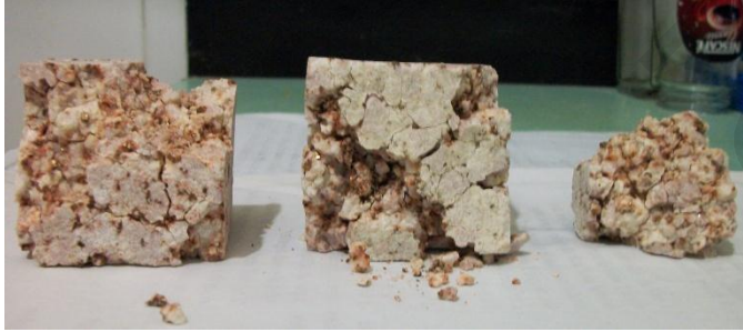
(صورة: ٢٢٩ أ-ب) توضح ما حدث من تغيرات للجرانيت الوردي بعد تعرضه لعدد من دورات التجوية الملحية و الحرارية بأملاح كلوريد الصوديوم حيث نلاحظ التشرخات و الهالات الحمراء حول معادن الميكا السوداء نتيجة التأكسد و التفتت الشديد و البلورات الذهبية الصغيرة و التي يشير السهم إلى واحدة منها.
