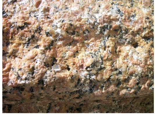
(صورة: ٣٦٢ أ - ب ) توضح الأصفرار الملحوظ على القطعة و الذى يرجح أنه نتيجة لتأكسد لعناصر المعدنية الموجودة بالقطعة .
