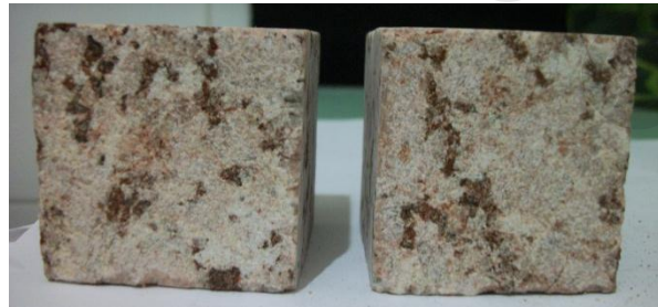
(صورة: ٢٢٩ أ-ب) توضح ما حدث من تغيرات للجرانيت الوردي بعد تعرضه لعدد من دورات التجوية الملحية و الحرارية بأملاح كلوريد الصوديوم حيث نلاحظ التشرخات و الهالات الحمراء حول معادن الميكا السوداء نتيجة التأكسد و التفتت الشديد و البلورات الذهبية الصغيرة و التي يشير السهم إلى واحدة منها.
