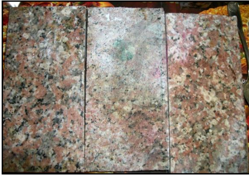
(صورة : ٣٣٧ أ و ب ) توضح بقع الصدأ و الأصفرار نتيجة لتأكسد المعادن الموجودة على أنواع الجرانيت المختلفة في الصورة اليمنى قبل التنظيف ، و المكعبات بعد التنظيف في الصورة اليسرى.
