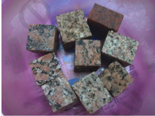
(صورة: ٢٢٨ أ-ب) مكعبات الجرانيت المختلفة الأنواع قبل و بعد الغمر في أملاح كلوريد الصوديوم و قبل وضعهم في حرارة الفرن.
