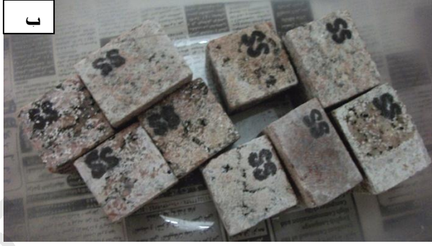
(صورة: ٢٢٤) توضح مكعبات الجرانيت الأنواع بعد الغمر في أملاح كبريتات الصوديوم و قبل وضعهم في درجة حرارة الفرن.
