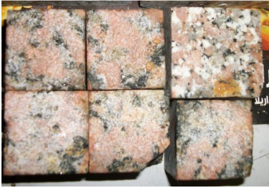
(صورة : ٣٣٧ أ و ب ) توضح بقع الصدأ و الأصفرار نتيجة لتأكسد المعادن الموجودة على أنواع الجرانيت المختلفة في الصورة اليمنى قبل التنظيف ، و المكعبات بعد التنظيف في الصورة اليسرى.
