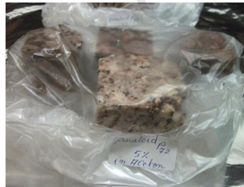
(صورة: ٢٧٤ أ ب) توضح عملية لف المكعبات الجرانيتية بالأكياس البلاستيكية بعد غمرها فى محاليل التقوية لإتمام عملية البلمرة.
