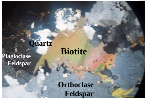
(صورة : ١٤٦ ) يوضح قطاع S3 معدن الكوارتز إلى أعلى اليمين و معدن البيوتيت ذو اللون البنى بتداخلات الألوان فى المنتصف ثم معادن الفلسبار الرمادية إلى أسفل اليمين و المنتصف ومعدن الكوارتز ذو اللون الأبيض بين البيوتيت ذو اللون البنى ومعدن الفلسبار بلاجيوكليز ذو اللون الداكن.
