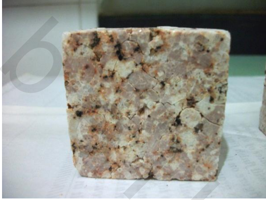
(صورة: ٢٣٣) حدث تغيرات للجرانيت الوردي بهتان للون وبعض الشروخ العميقة و لكن لم يصل إلى مرحلة التفتت بعد تعرضه لعدد من دورات التجوية الملحية و الحرارية بيكرينات الأمونيوم.
