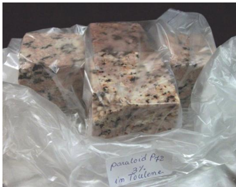
(صورة: ٢٧٤ أ ب) توضح عملية لف المكعبات الجرانيتية بالأكياس البلاستيكية بعد غمرها فى محاليل التقوية لإتمام عملية البلمرة.
