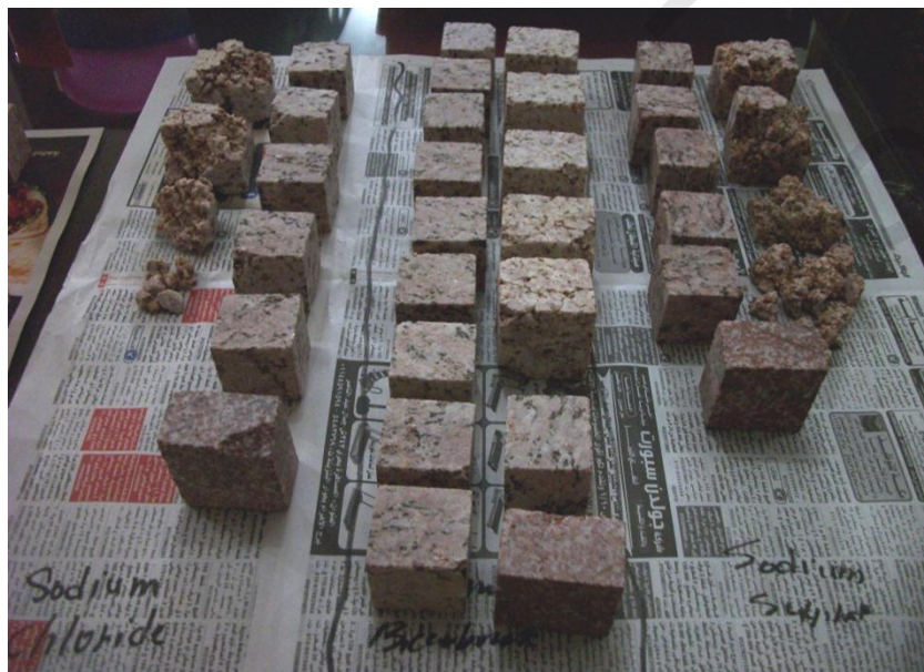
(صورة : ٢٢٣) توضح ما حدث لمكعبات الجرانيت المختلفة الأنواع بعد تعرضها لدرجات الحرارة المختلفة.
