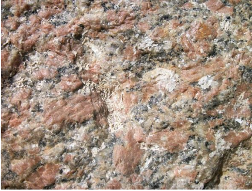
(صورة: ٣٦٢ أ - ب ) توضح الأصفرار الملحوظ على القطعة و الذى يرجح أنه نتيجة لتأكسد لعناصر المعدنية الموجودة بالقطعة .
