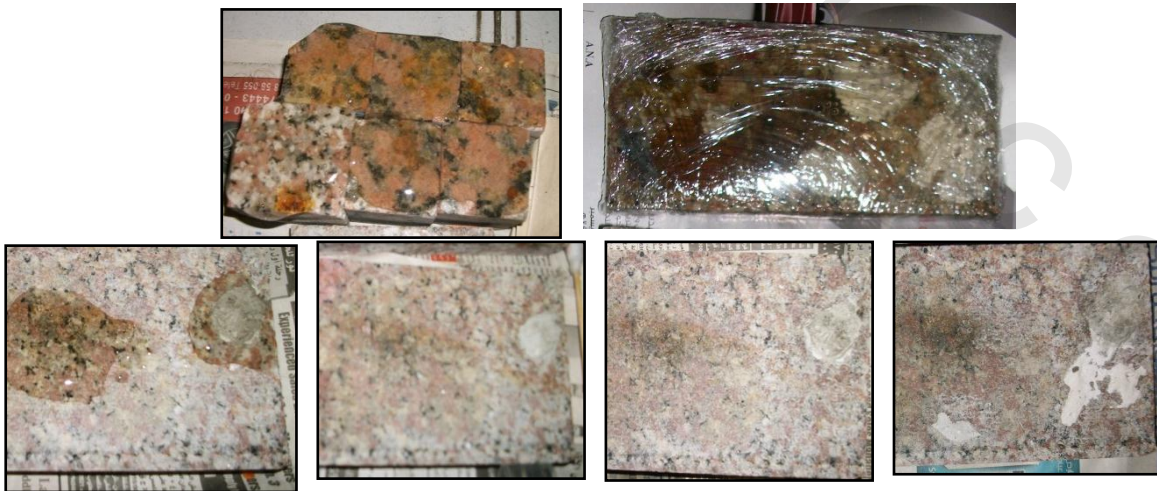
( صورة: ٣٢٧ أ ب- ج د ) توضح عملية إزالة التكلسات الجبسية و الأسمنتية باستخدام كمادة الكربوكسى ميثيل سيليلوز و كربونات الأمونيوم المضاف إليها الأديتا بوتاسيوم و التى أعطت نتائج جيدة فى إزالة التكلسات و لكن لم تعطى إزالة بشكل نهائى للتكلسات الأسمنتية الشديدة.
