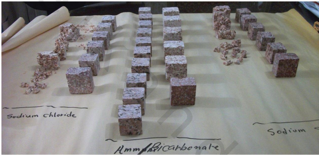
( صورة : ٢٢٢ ) توضح ما حدث لمكعبات الجرانيت المختلفة الأنواع و التي تم غمرها في أملاح كبريتات الصوديوم و كلوريدات الصوديوم و بيكربونات الأمونيوم بعد تعرضها لدرجات الحرارة المختلفة.
