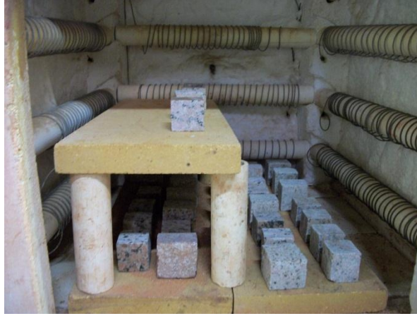
(صورة : ٢٢١) توضح المكعبات داخل الفرن بعد تعرضها لعملية التجوية الملحية و قبل تعرضها لدرجات الحرارة المختلفة .
