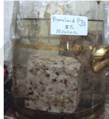
(لوحة : ٢٧٣) توضح غمر مكعبات الجرانيت المختلفة الأنواع فى محاليل التقوية
