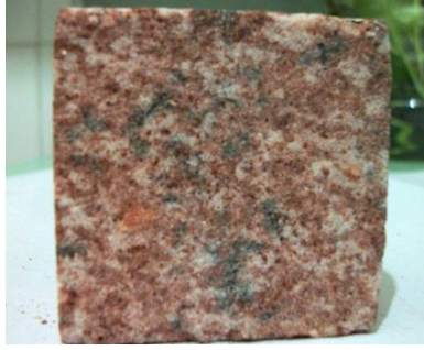
(صورة: ٢٢٧ أ-ب) حدثت تغيرات للجرانيت الأحمر الداكن بعد تعرضه لعدد من دورات التجوية الملحية و الحرارية بأملاح كبريتات الصوديوم.
