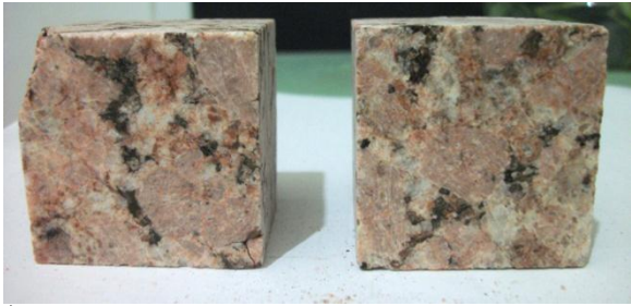
(صورة: ٢٣٤ أ-ب) يوضح ما حدث من تغيرات للجرانيت الأحمر الفاتح حيث حدوث بهتان للون بعد تعرضه لعدد من دورات التجوية الملحية و الحرارية بأملاح بيكرينات الأمونيوم.
