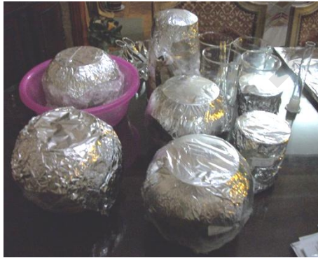
(لوحة : ٢٧٣) توضح غمر مكعبات الجرانيت المختلفة الأنواع فى محاليل التقوية
