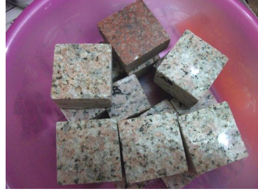
(صورة : ٢٣٢ ) مكعبات الجرانيت المختلفة الأنواع بعد الغمر فى بيكرينات الأمونيوم و قبل وضعهم فى درجة حرارة الفرن.
