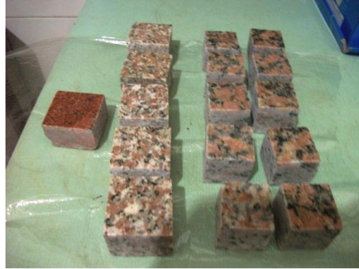
(صورة: ٢٢٨ أ-ب) مكعبات الجرانيت المختلفة الأنواع قبل و بعد الغمر في أملاح كلوريد الصوديوم و قبل وضعهم في حرارة الفرن.
