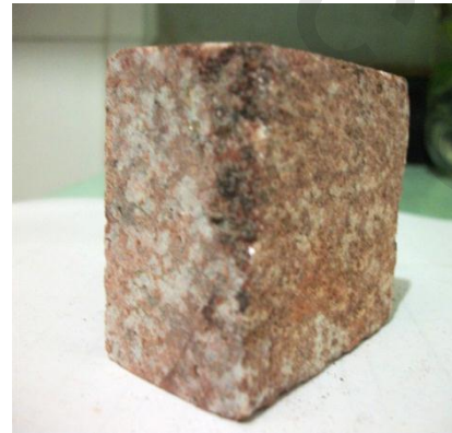
(صورة: ٢٣٥ أ-ب) يوضح ما حدث من تغيرات للجرانيت الأحمر الداكن حيث حدوث بهتان للون و خشونة بعد تعرضه لعدد من دورات التجوية الملحية و الحرارية بأملاح بيكرينات الأمونيوم.
