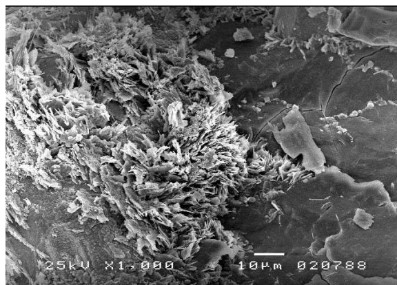
(صورة : ٣١٥ ) يتضح من الفحص لعينة الجرانيت الأحمر الفاتح اللزوجة المرتفعة للبوليمرات أدت إلى حدوث تشقق في فيلم ( الطبقة الرقيقة المادة المقوية P72 ٣% في التولوين ( قوة تكبير 1,000X ).
