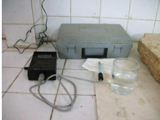
(صورة: ٣٥٣) توضح الجهاز المستخدم لقياس نسبة الملوحة عند إجراء عملية التحلية بمعمل الترميم بالمسرح الرومانى
